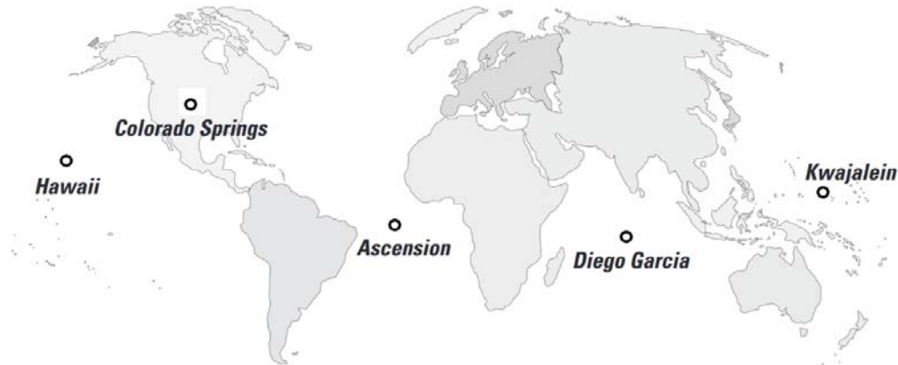
Figura 2.87. Estaciones del segmento de control.
