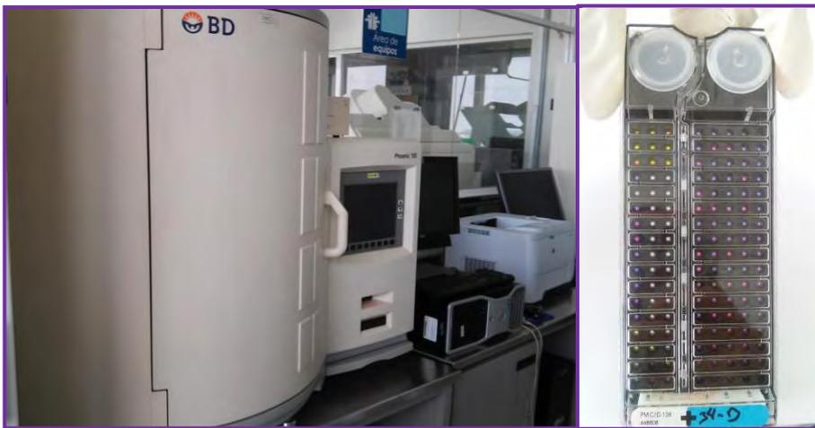
**Figura 5. Equipo automatizado BD PHOENIX 100<sup>®</sup> y placas para la identificación y sensibilidad antimicrobiana.**
