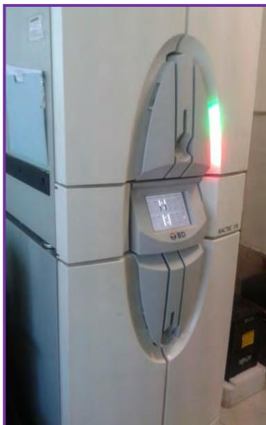
Figura 4. Equipo automatizado para Hemocultivos BD BACTEC<sup>®</sup> FX
