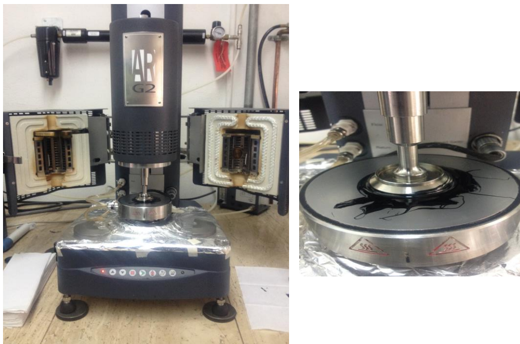
Figura 6. Izquierda: reómetro AR-G2 esfuerzo controlado; derecha: muestra de crudo.
