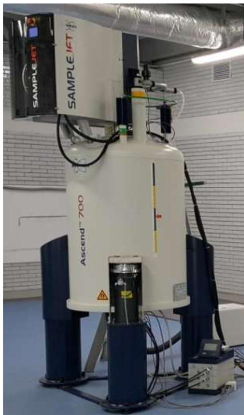
Figura 2. Espectrómetro Bruker Avance III HD 700 MHz (campo magnético de 16.4 T).
