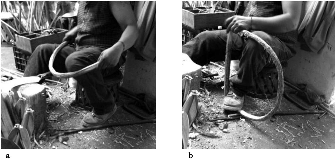
Fig. 88. Proceso para realizar la guarnición (aro). a) Se dobla manualmente la pieza de madera; b) se clava y se amarra en ambos extremos a una pieza recta de la misma madera para unirlos. Fotografías tomadas por el autor.
