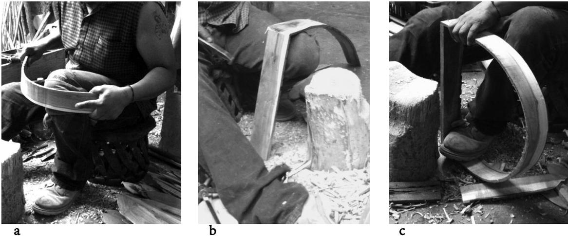
Fig. 84. Proceso de elaboración de la base (rueda), en la que se une una pieza recta y otra más delgada que se dobla para formar un arco. a) Se dobla la madera de forma manual para formar el arco; b) se clava uno de los extremos del arco a la pieza recta y de mayor espesor; c) por último se dobla el arco hasta alcanzar el otro extremo de la pieza recta para clavarla y que queden unidas. Fotografías tomadas por el autor.
