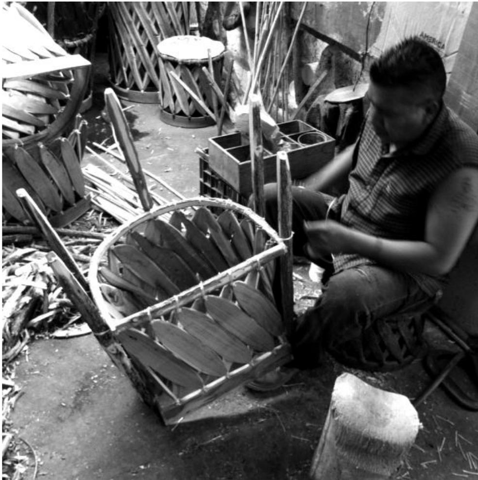
Fig. 91. Los cinco largueros se sujetan a la estructura principal del equipal. Fotografía tomada por el autor.
