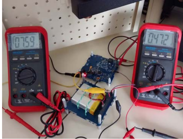
Figura 6.1: Pruebas de carga de baterías
