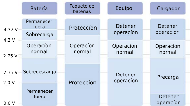
Figura 4.4: Niveles de Voltaje de las Baterías
