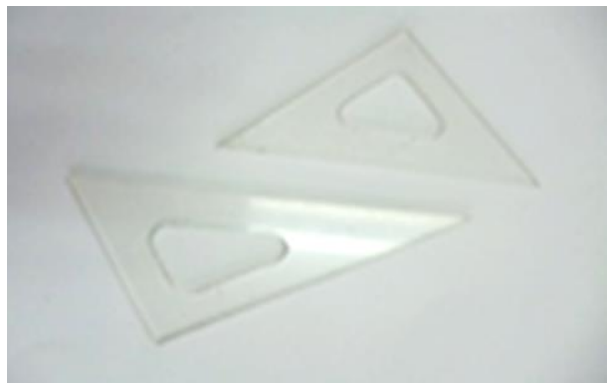
Escuadras instrumento de acrílico, para trazar líneas rectas y marcar ángulos.
