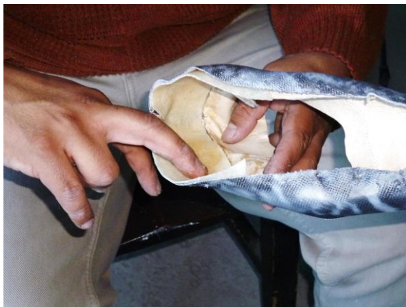
237. Embarramos cemento balco al contraorte, para pegarlo con el forro.
