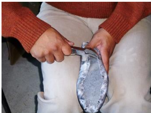
215. El 9 paso a la altura del enfranque en el lado exterior.
