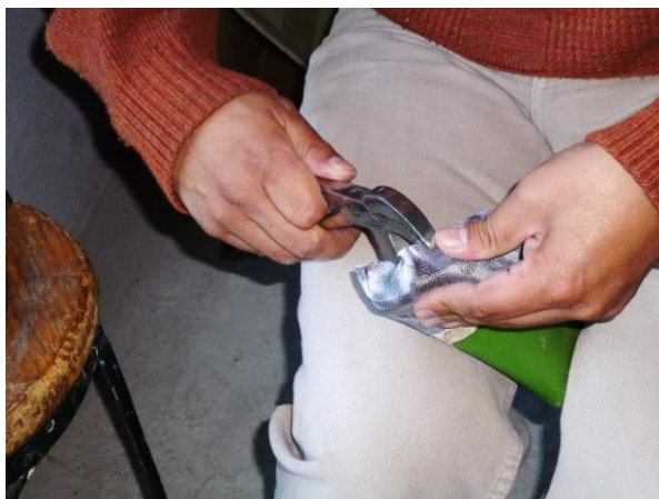
216. Se aplica la técnica con las pinzas de montar, separando las arrugas del corte en la punta.
