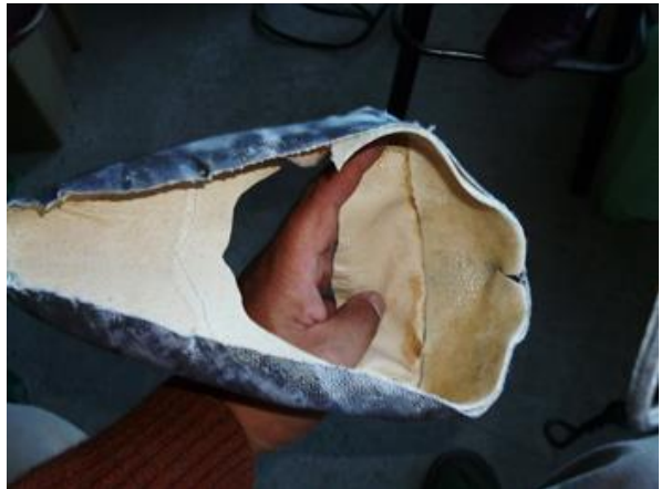
236. Verificamos si está centrado y entallado el contraorte en el corte.
