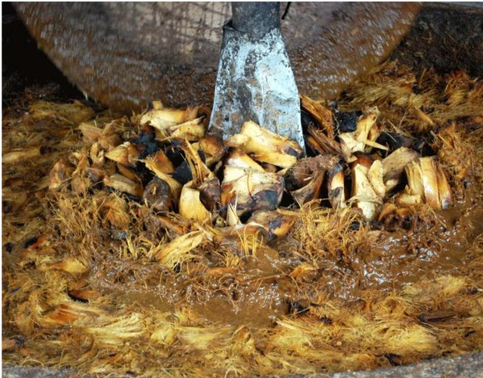
Figura 1.21 Agave cocido triturado en el interior del molino de piedra.
