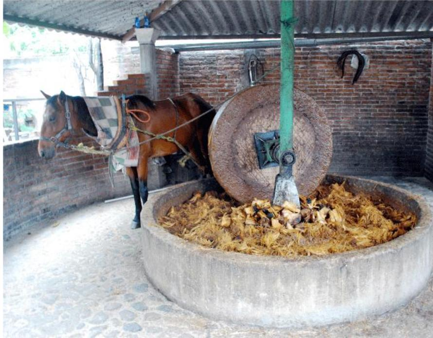
Figura 1.20 Molino de piedra tirado por un caballo. En el interior del molino se encuentran las piñas cocidas y trituradas.
