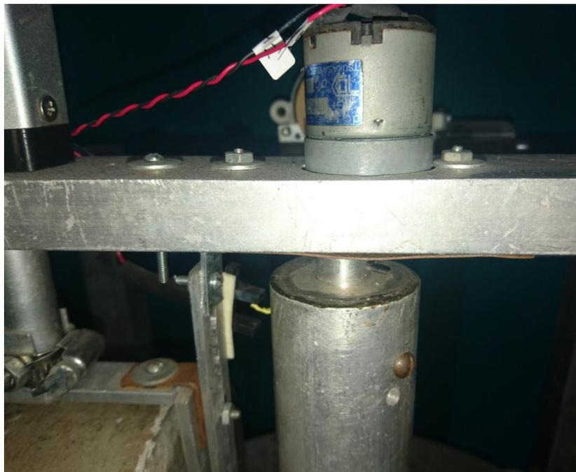
Figura 3.22 Acoplamiento del motor con el eje principal
