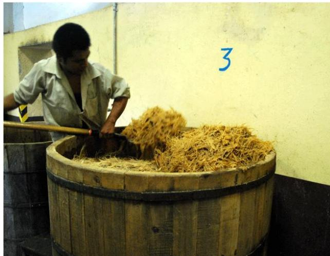
Figura 1.25 Redistribución de bagazo en el proceso de fermentación
