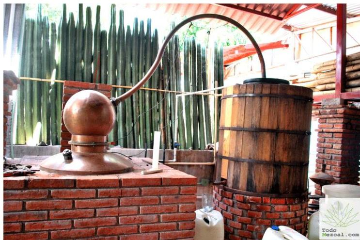
Figura 1.28 Alambique de cobre enfriado con agua
