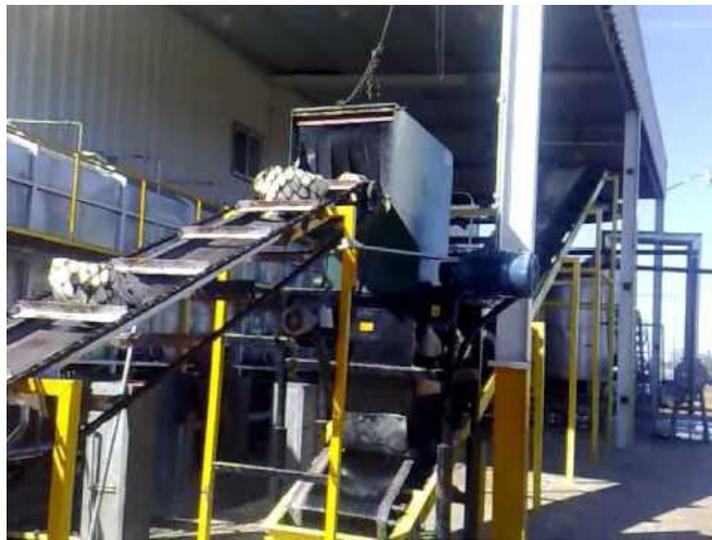
Figura 2.3 Desgarradora industrial de agave
