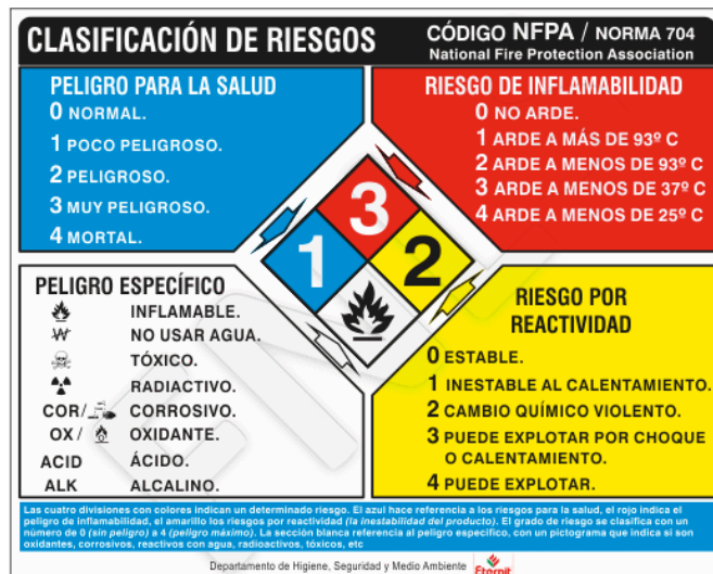
Figura 49. Rombo National Fire Protection Association. Etiqueta de seguridad. Clasificación de riesgos.
