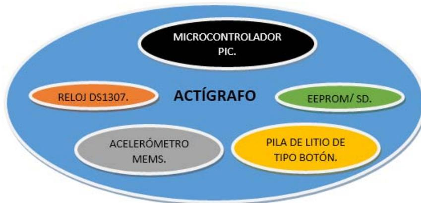
FIGURA 2. 2. Aproximación del circuito para el Actígrafo.
