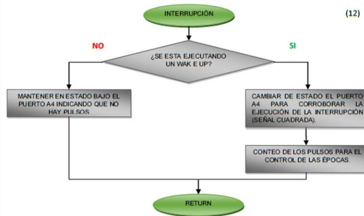
FIGURA 3. 3. Diagrama de flujo de la interrupción por cambio de nivel.
