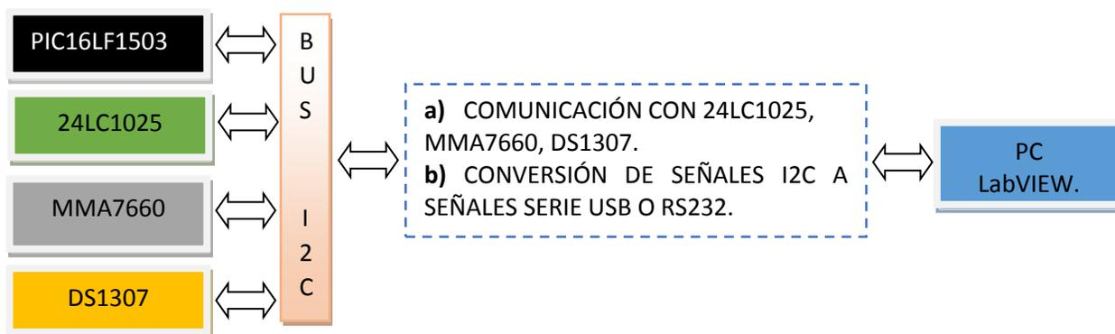
FIGURA 2. 3. Comunicación del Actígrafo con la PC.
