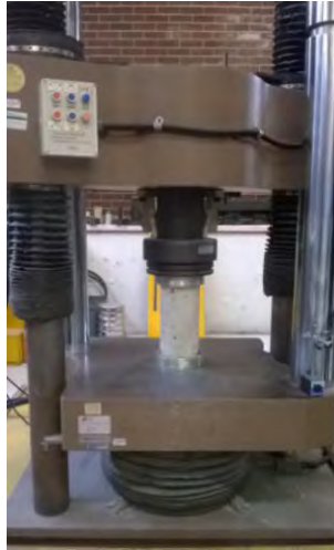
Fig. 3.13 Ensayo a compresión.
