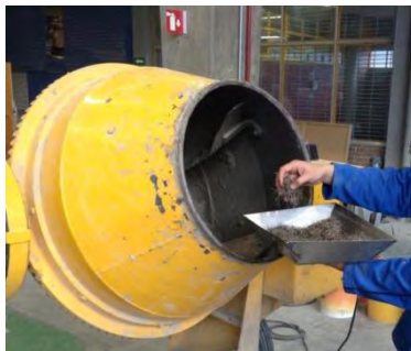
Fig. 3.5 – Adición de fibras
