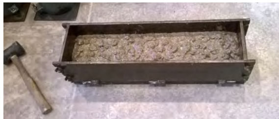
Fig. 3.8 – Elaboración de viga.
