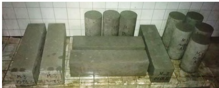
Fig. 3.11 - Especímenes en la cámara de curado.
