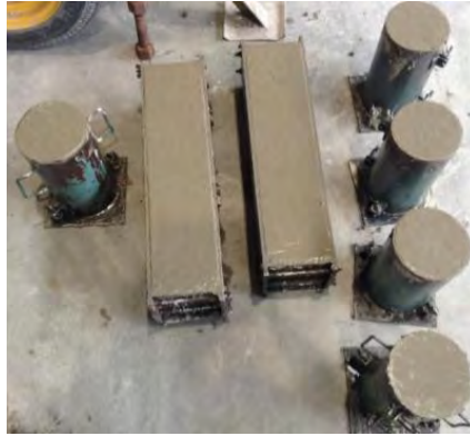
Fig. 3.9 – Especímenes recién fabricados
