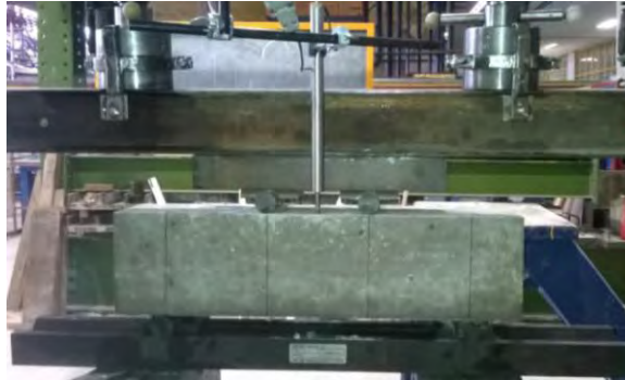
Fig. 3.15 – Ensayo de viga a flexión.
