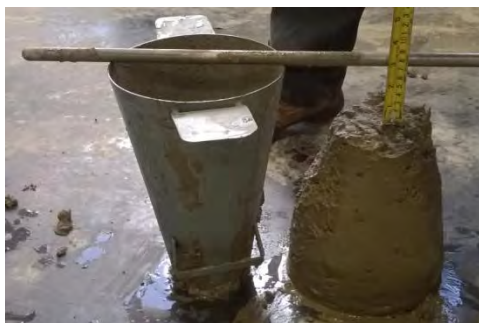
Fig. 3.6 – Prueba de revenimiento.
