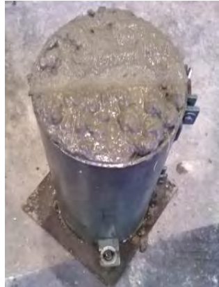
Fig. 3.7 – Elaboración de cilindro
