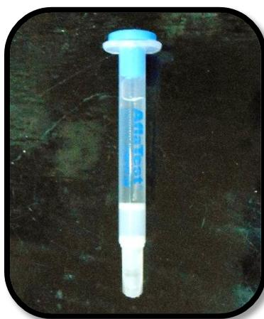
**Figura 17. Columnas de anticuerpos monoclonales (AflaTest®).
