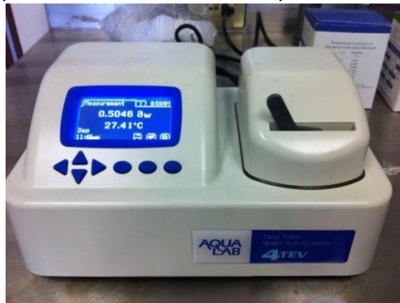
Figura 4.6. Medidor de actividad Aqua Lab, modelo Dew Point Water Activity Meter- 4TEV.
