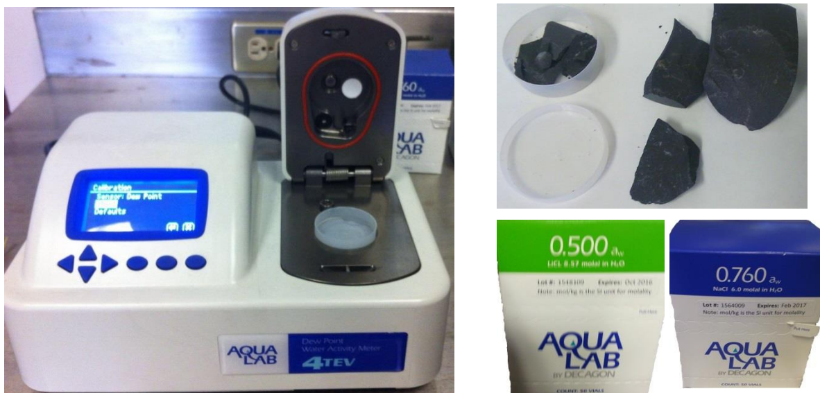
Figura 4.7. Equipo para medición de actividad, muestra de núcleo P1 y estándares de calibración.
