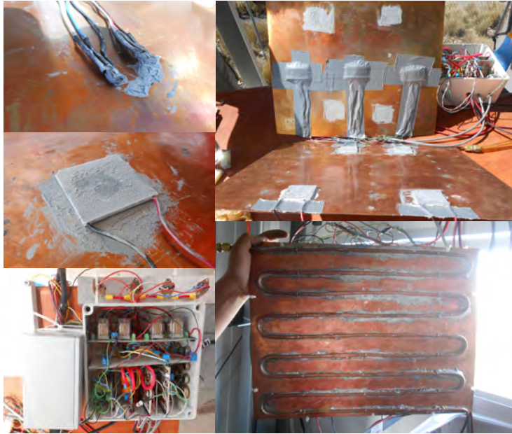
Figura 3.7: Arriba izq: Sensor de temperatura. En medio izq: celda Peltier. Abajo izq. Circuitos del Control de temperatura. Arriba der. interior cuerpo negro. Abajo der. Tubería por donde circula agua para disipar el calor.
