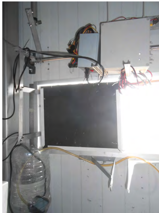
Figura 3.5: Sistema de cuerpo negro automatizado e instalado en Alzomoni, abril 2015
