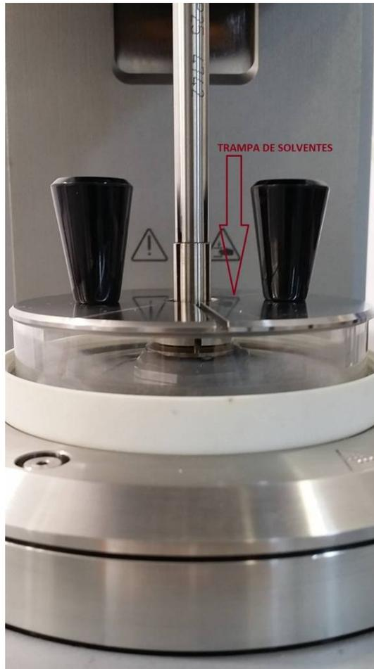
**Figura 8.** Módulo de prueba del reómetro con platos paralelos al centro y trampa de solventes sobre estos, las perillas negras pertenece a esta trampa de solventes, en el cristal se puede observar el vapor en el espacio de trabajo.
