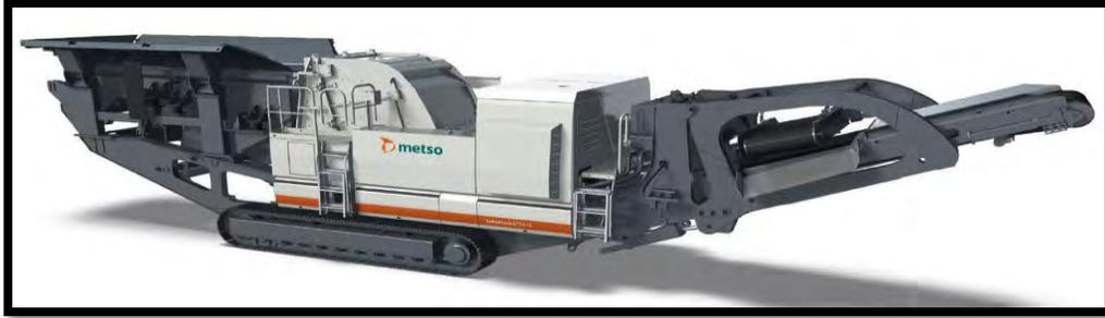
*Figura 5. Trituradora de impacto horizontal (Fuente: Metso Minerals 2014).*
