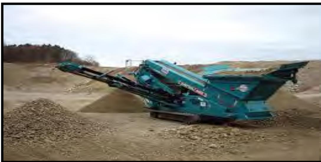
*Figura 13. Criba de trituración, como clasificación de los distintos tipos de agregados reciclados.
