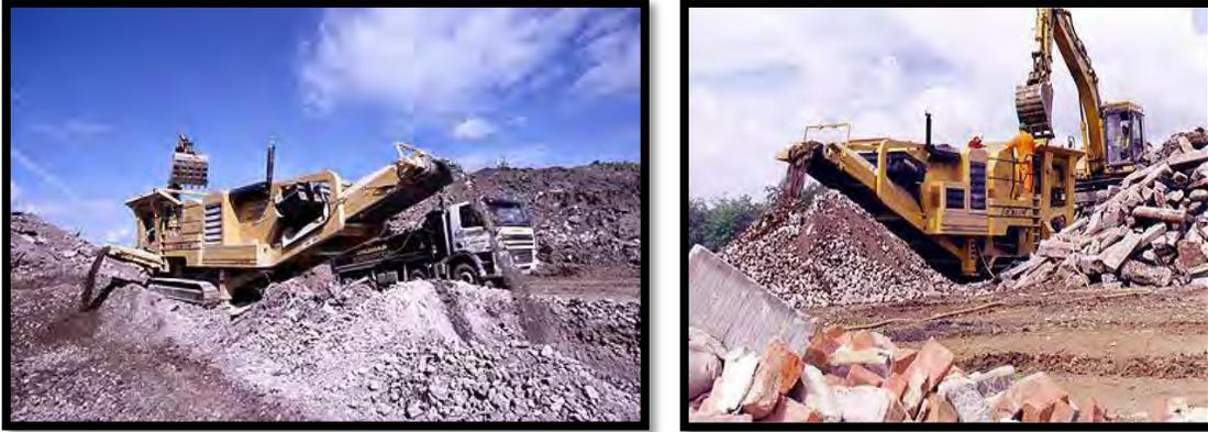
*Figura 9. Trituradora de quijadas Extec con capacidad de 480 ton/día. (Fuente: catálogo de equipos Extec)*
