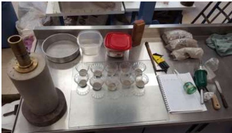
Fotografía 4.4.- Materiales y herramientas empleadas en las pruebas de compactación.
