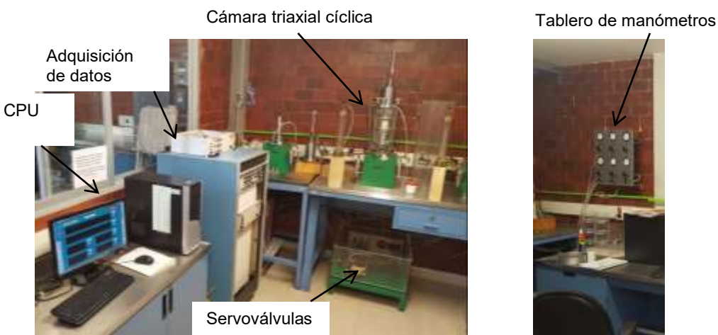
Fotografía 3.1.- Esquema de una cámara triaxial dinámica.
