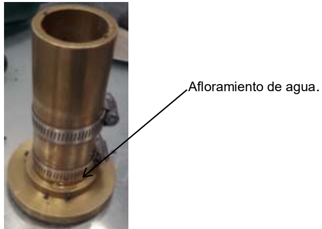
Fotografía 4.5.- Afloramiento de agua durante la ejecución de las pruebas de compactación, para w=3000 g y w=10\% .
