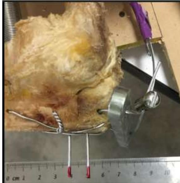
**Figura 15. Se coloca un clavo a cada lado de la fractura para medir la separación de los fragmentos durante y al final de las pruebas.**
