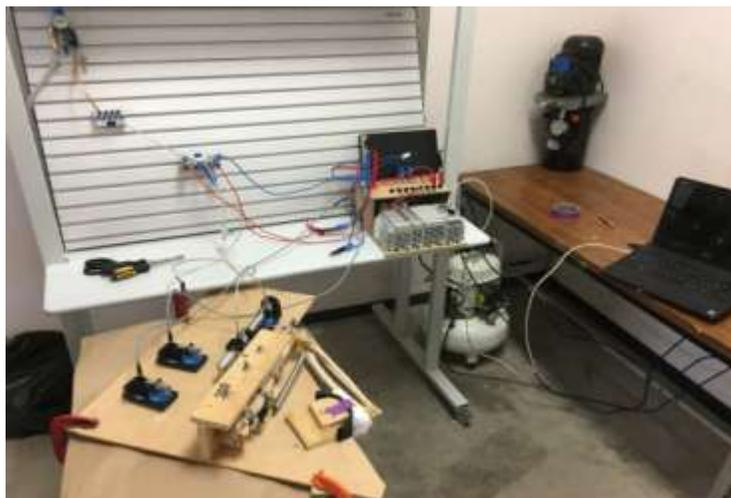
Figura 12. Dispositivo de cargas cíclicas para las pruebas.
