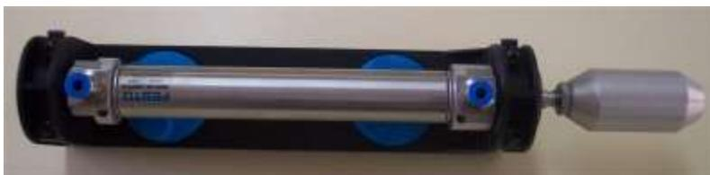
**Fig. 11. Cilindro neumático de doble efecto utilizado para fabricar el dispositivo.**
