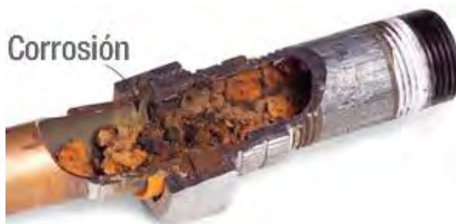
Figura 1.13 Corrosión en tubería 14
