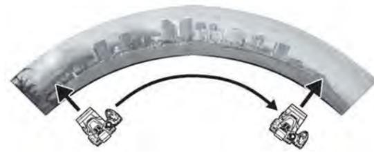
Ejemplo de paneo, rotación de la cámara sobre su propio eje, de izquierda a derecha.
