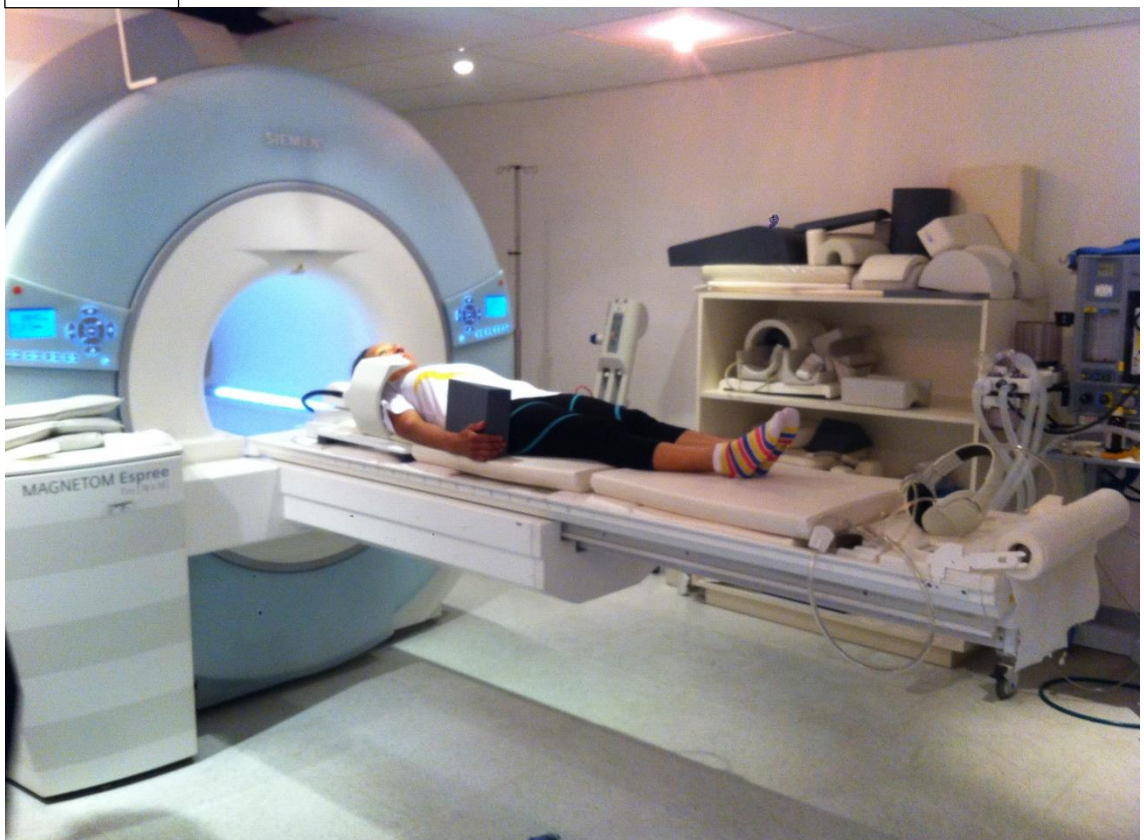
Resonador magnético del Hospital General Xoco tipo Magnetom Espree de 1.5 Teslas marca Siemens
