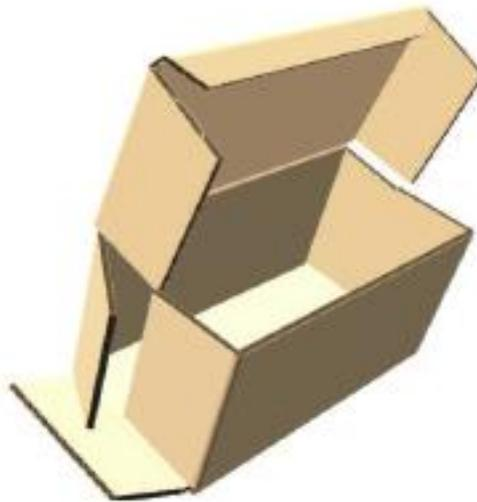
**La Caja Tipo Telescopio.** En este estilo de cubierta es del tipo de charola, se utiliza para los productos que requieren una exhibición directa o con necesidades de transportación y uso especiales. Normalmente el producto contenido soporta carga ampliamente.
