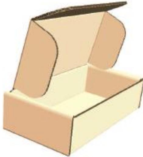
**La Caja Tipo Folder.** Funciona para envolver el contenido, podrían ser latas, cartones de leche de vidrio o de plástico, botellas, etc. En la etapa de envolver se cierra la aleta con pegamento. Las ventajas de este tipo de cajas se dan en armadoras automáticas, donde se produce un paquete justo que reduce la posibilidad de dañar el producto.
