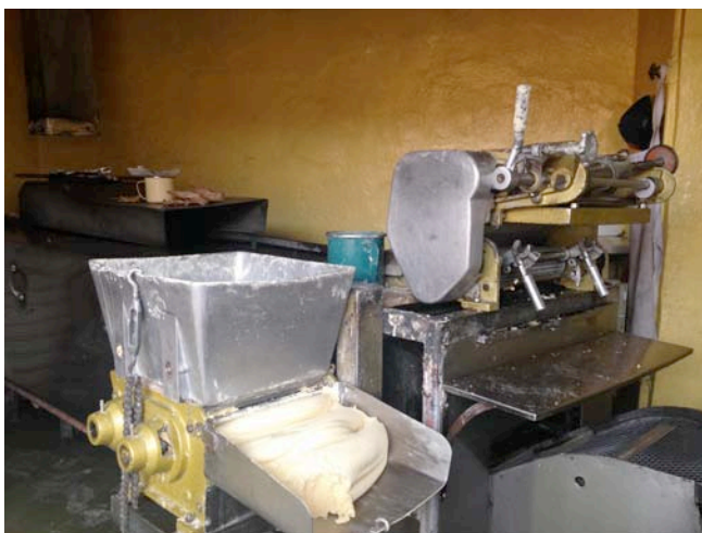
Común molino industrial utilizado en las principales ciudades de México para convertir maíz nixtamalizado en tortillas Foto: Luis Fernando Ruiz C.
