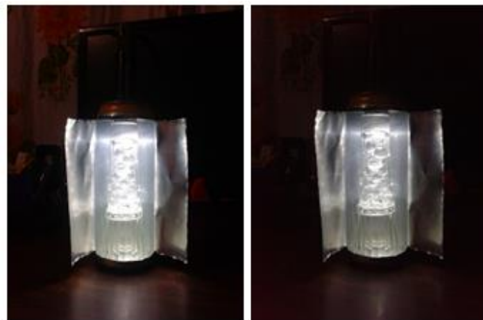
Ilustración 4-9. 5Prototipo de lámpara de dispersión con perlas de hidrogel.
