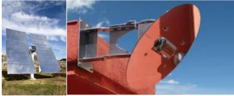
Ilustración 4-6. Helióstato común en parcelas solares (izq.). Helióstato para uso residencial (der).
