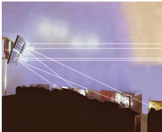
Ilustración 4-4. Imagen ejemplar de un heliostato iluminando una plaza y edificios en zonas de poca irradiación solar.
