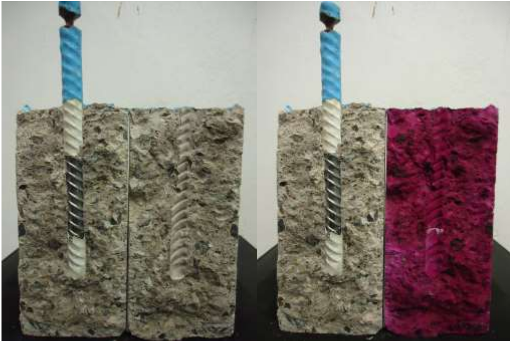
Figura 3.33.- Concreto con agregado reciclado antes de la carbonatación.
