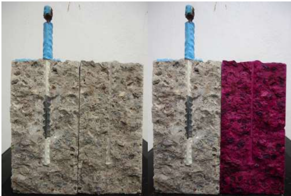
Figura 3.32.- Concreto con agregado natural antes de la carbonatación.
