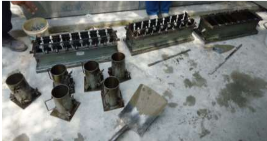
Figura 3.12.- Fabricación de vigas y cilindros de concreto.
