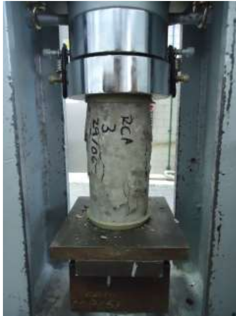
Figura 3.16.- Prueba de compresión.
