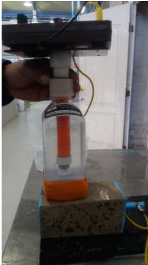
Figura 3.26.- Prueba de potencial de corrosión.
