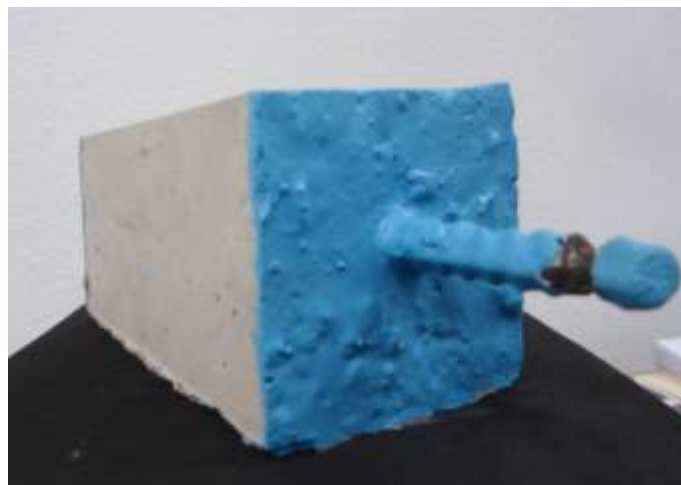
Figura 3.20.- Probeta para medición de potencial de corrosión.
