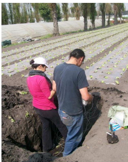
Figura 8. Instalación de electrodos en uno de los sitios de monitoreo con electrodos de platino para la medición de (POR)
