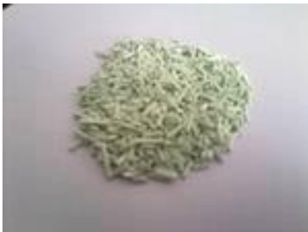
Figura 5. Catalizador cobalto-molibdeno. Es el catalizador que se utiliza para el proceso de hidrodesulfuración.
