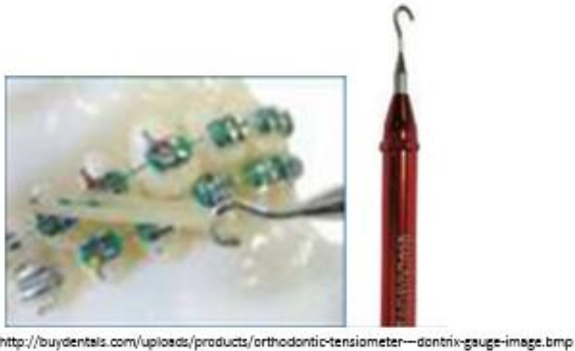
Fig. 40. Dinamómetro (Dentrix), para medir la fuerza para la tracción. Fuente Web.
