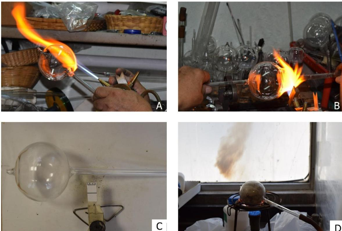
Figura 22. Proceso de modificación del tubo de pyrex por un artesano soplador de vidrio para adaptarlo a la metodología de blanqueado con cloruro de amonio aquí empleada (A y B); Tubo modificado, utilizado para el blanqueado de fósiles (C); Blanqueado de fósiles utilizando el tubo de pyrex modificado, en la foto se observa el cloruro de amonio en forma gaseosa saliendo copiosamente (D).
