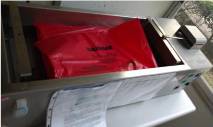
Figura 21. Baño María a 45°C con agitación, en la imagen con muestras de coliformes fecales en incubación.
