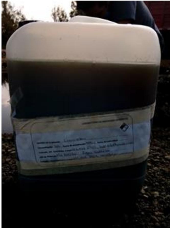
Figura 14. Muestra de lixiviados recién extraídos del cárcamo en relleno sanitario Bordo Poniente.
