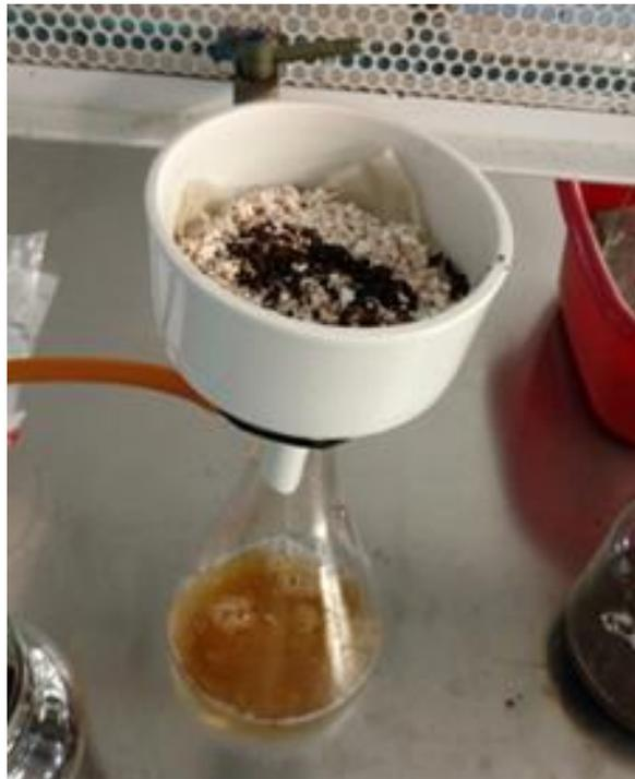
Figura 18. Filtro de huevo en funcionamiento.
