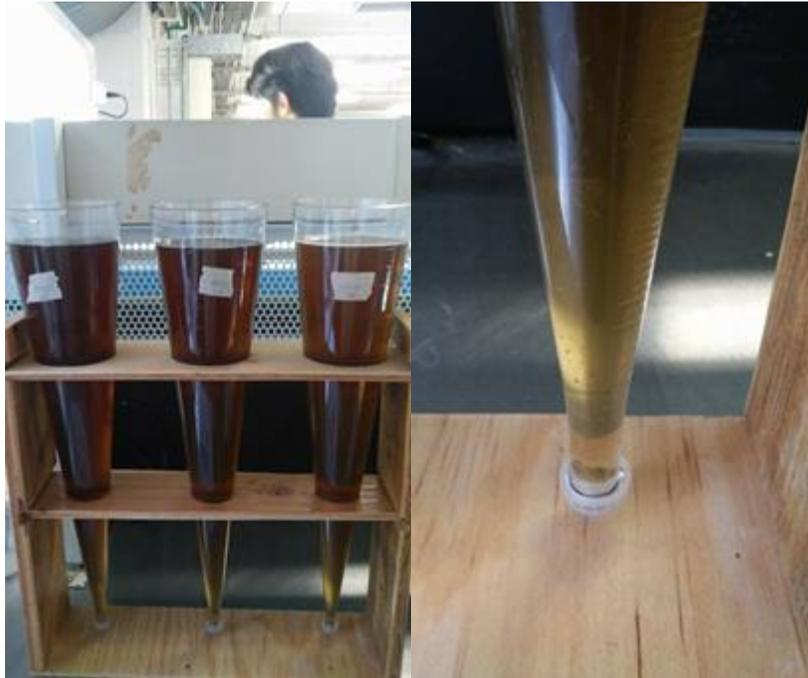
Figura 19. Pruebas de sólidos sedimentables de Imhoff.
