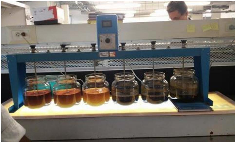
Figura 16. Prueba de jarras utilizando sábila *Aloe vera* en base húmeda y seca.
