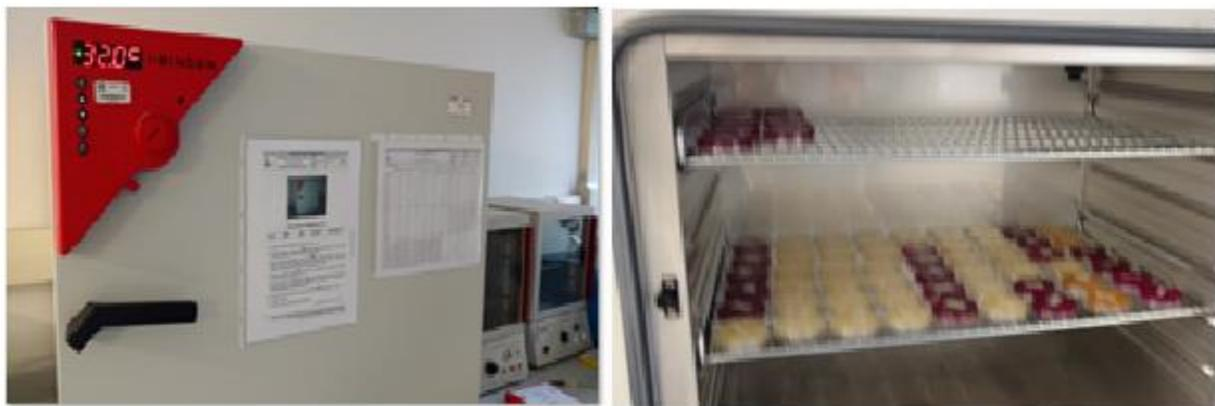
Figura 22. Incubadora, a 35°C se utilizaba para incubar coliformes totales y bacterias heterotróficas.
