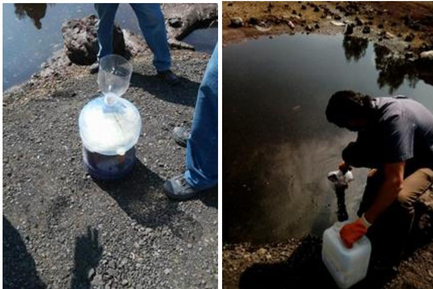
Figura 7. Muestreo de lixiviados en relleno sanitario Bordo Poniente.
