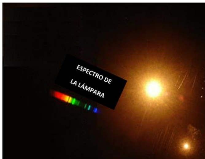
Figura 27. Espectro de emisión de la lámpara de sodio (a alta presión) que se utiliza en el alumbrado público.
