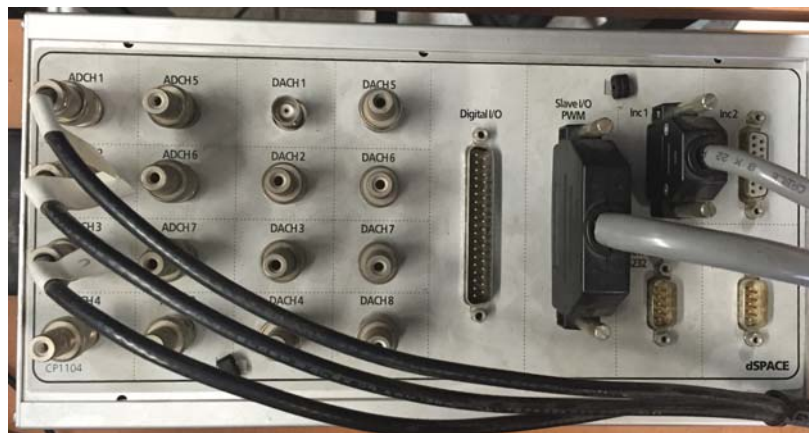
FIGURA A.1: Bornera de conexiones de la tarjeta de adquisición dSPACE
