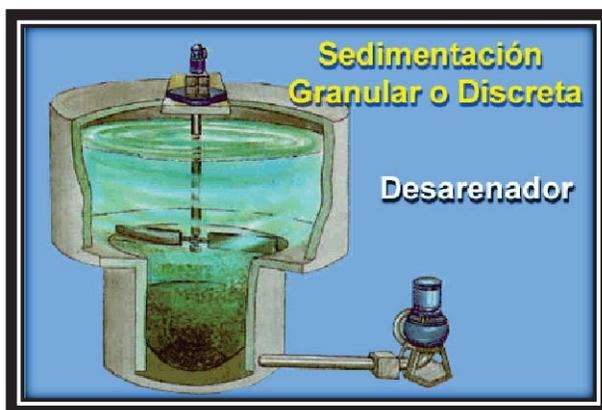
Figura 7. Sedimentación discreta o granular.
