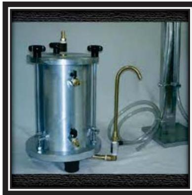
Figura 36. Permeámetro utilizado en el laboratorio
