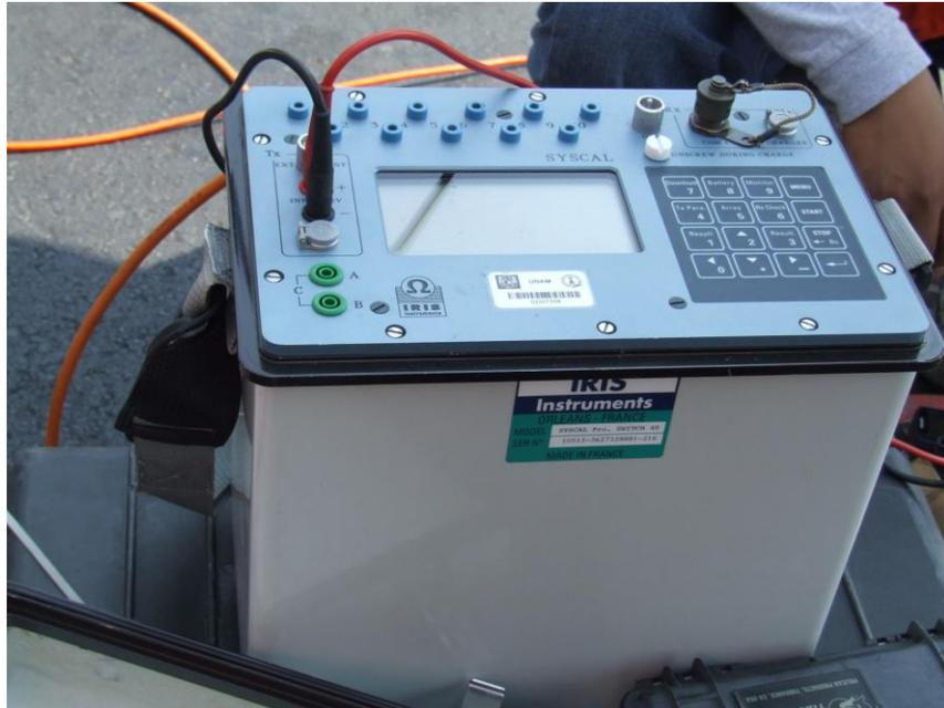
**Fotografía 3.** Resistivímetro *SYSCAL Pro Switch 48* de IRIS Instruments.
