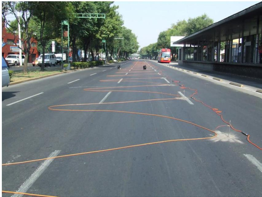
**Fotografía 1.** Conexión de cable multipolar a electrodos en TRE-Línea 1.
