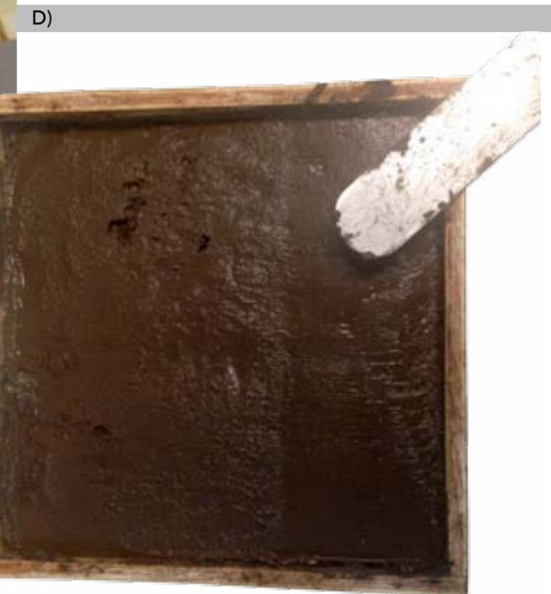
Figura 76. Fabricación de los adobes modelo. a) mezcla en molde, b) golpeo con espátula, c) terminado superior, d) adobe terminado.
