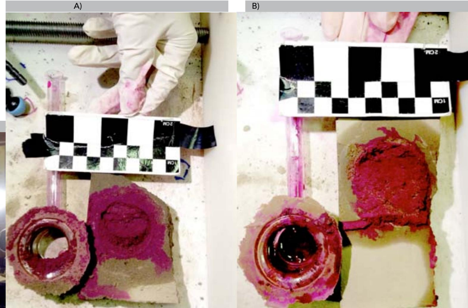
**Figura 85.** Imágenes finales del experimento donde se observa la erosión superficial en la zona de contacto con el agua en geometría tubo Karsten vertical. A) experimento en seco, b) experimento en húmedo.
