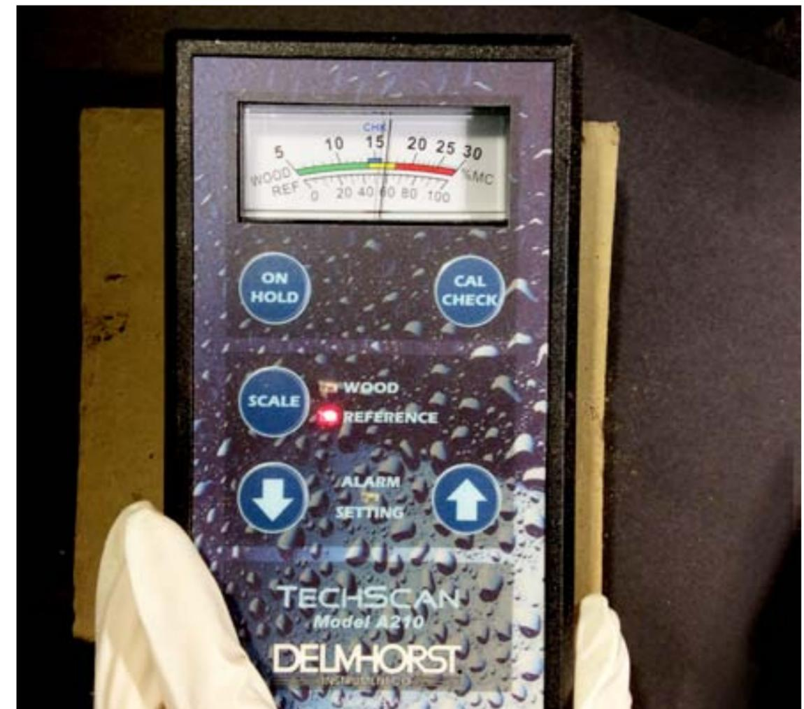
Figura 78. Medición de humedad en superficie con higrómetro portátil.
