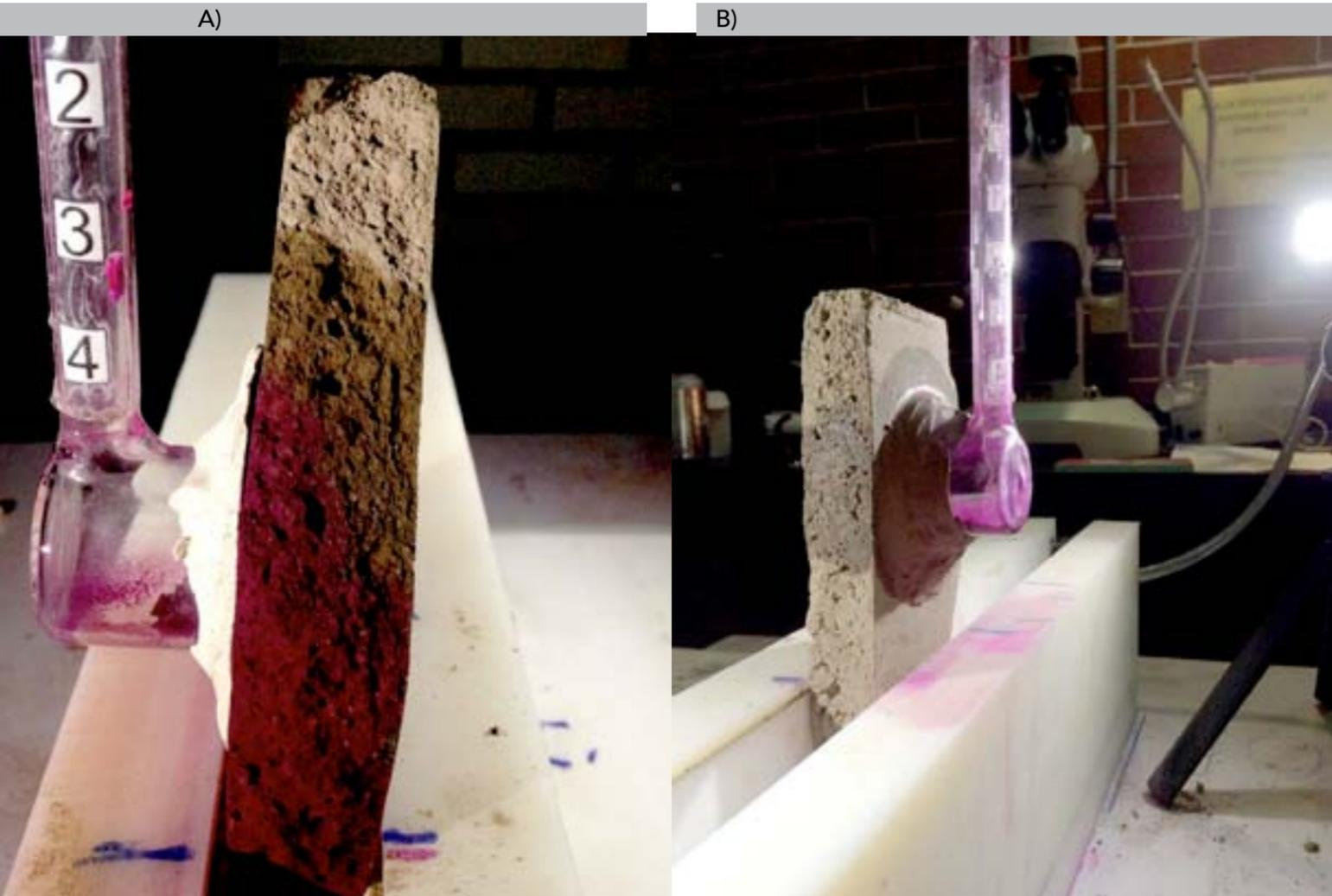
**Figura 84.** imágenes finales del experimento donde se observa el frente de mojado, así como la erosión superficial en la zona de contacto con el agua en geometría tubo Karsten vertical. A) experimento en seco, b) experimento en húmedo.
