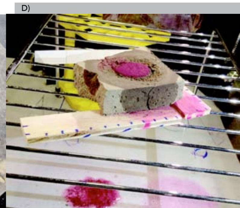
Figura 89. Imágenes finales del experimento donde se observa la erosión superficial en la zona de contacto con el agua en geometría tubo Karsten horizontal. a) y b) experimento en seco, c) y d) experimento en húmedo.
