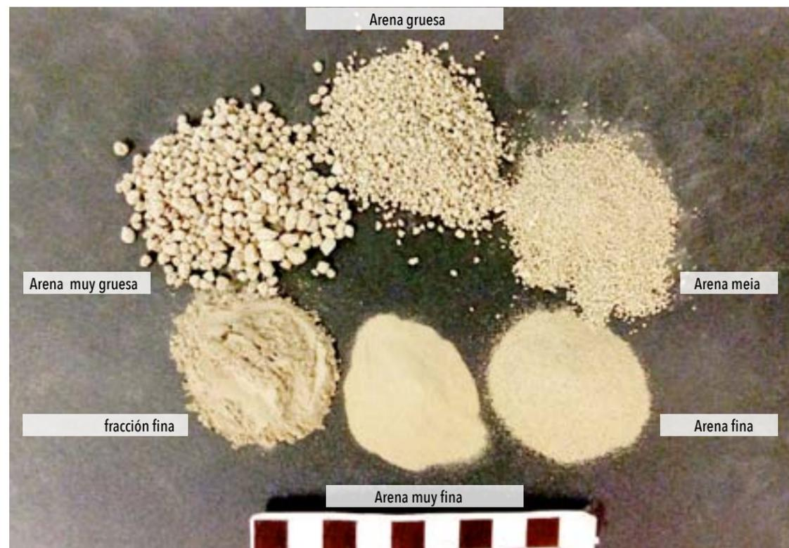
FIGURA 50. FOTOGRAFÍA DE LAS FRACCIONES GRANULOMÉTRICAS.
