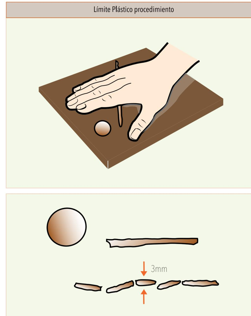
Figura 41. Procedimiento para determinar el límite plástico en suelos de acuerdo a norma ASTM D4318.
