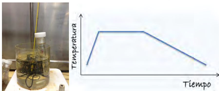
Figura 35. A la izquierda, una fotografía del sistema y los reactores utilizados para llevar a cabo las síntesis solvotermales. A la derecha un esquema de una posible rampa de temperaturas para la síntesis solvotermal 142 .
