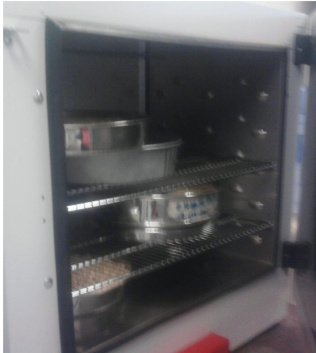
Figura 9. Ajuste de maíz a humedades de 9% y 11% por medio de estufa Red Line.
