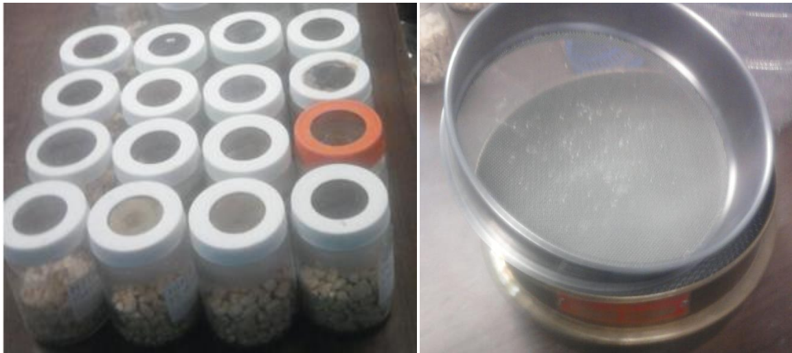
Figura 16. Tapas de almacenamiento abierto (izquierda); zarandas manuales (derecha).
