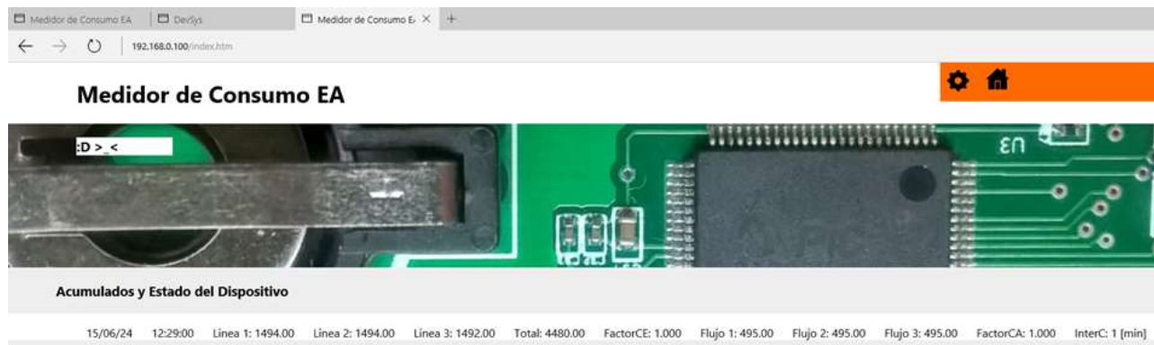
Figura 4.12 Página de inicio del Medidor de Consumo EA con resultados de pruebas de captura de todas las líneas y flujos activos
