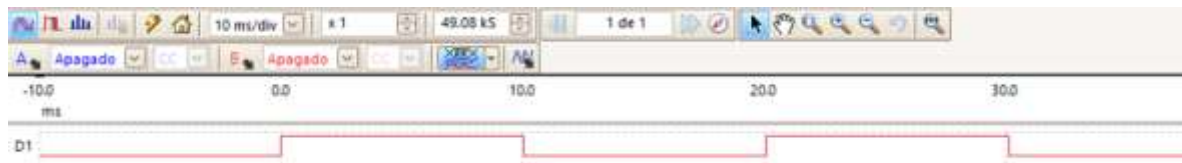
Figura 4.7 Señal con frecuencia de 50[Hz] utilizada para probar velocidad de captura del núcleo de comunicación Ethernet
