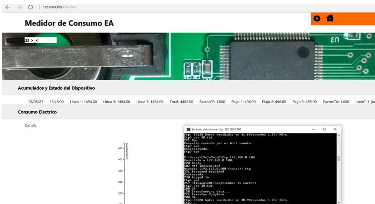
Figura 4.13 Página de inicio del Medidor de Consumo EA con resultados de prueba de captura de todas las líneas y flujos activos, además de consola de comandos con resultado de transferencia de archivo vía FTP
