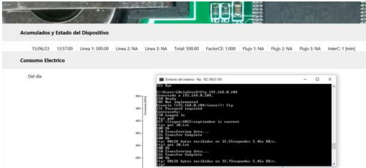
Figura 4.11 Página de inicio del Medidor de Consumo EA con resultado de prueba de captura de línea y consola de comandos con resultado de transferencia de archivo vía FTP
