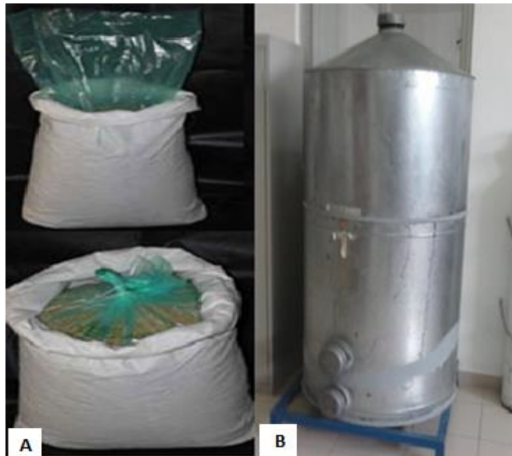
Figura 11. a) Almacenamiento de granos en sacos de plástico multilaminado, se extrae el aire dentro del saco y se asegura su hermetismo mediante el amarrado de la bolsa; b) Silo hermético de metal (Imágenes de Grain Pro Inc., y del laboratorio de UNIGRAS, FES-Cuautitlán.).
