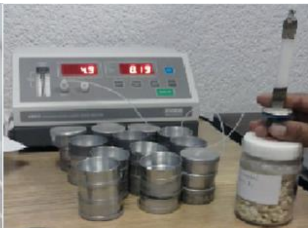
Figura 21. Muestreo de las UE con cerrado hermético para la concentración de oxígeno y dióxido de carbono con un analizador de gases Illinois 6600.
