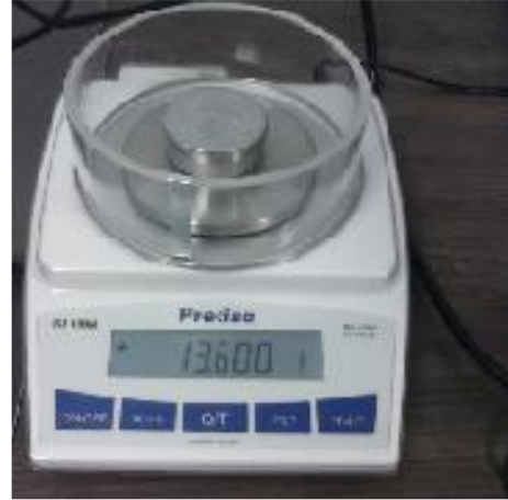
Figura 24. Pesaje de las muestras secas del grano de maíz para la determinación de CH.
