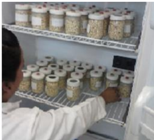
Figura 20. Arreglo aleatorio de las UE dentro de la cámara de incubación a 25°C
