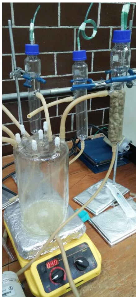
Fig. 30. Arreglo único para cada reactor tubular.
