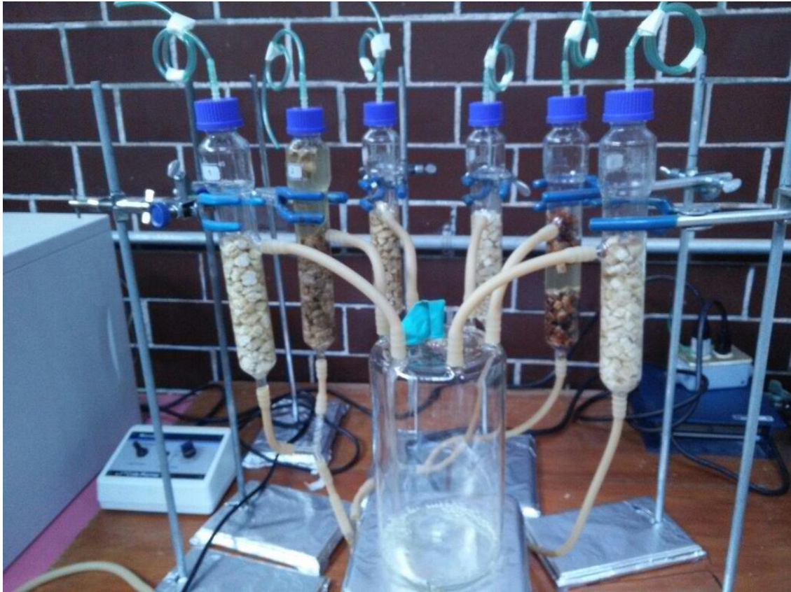
Fig. 28 . Arreglo en serie de reactores tubulares.
