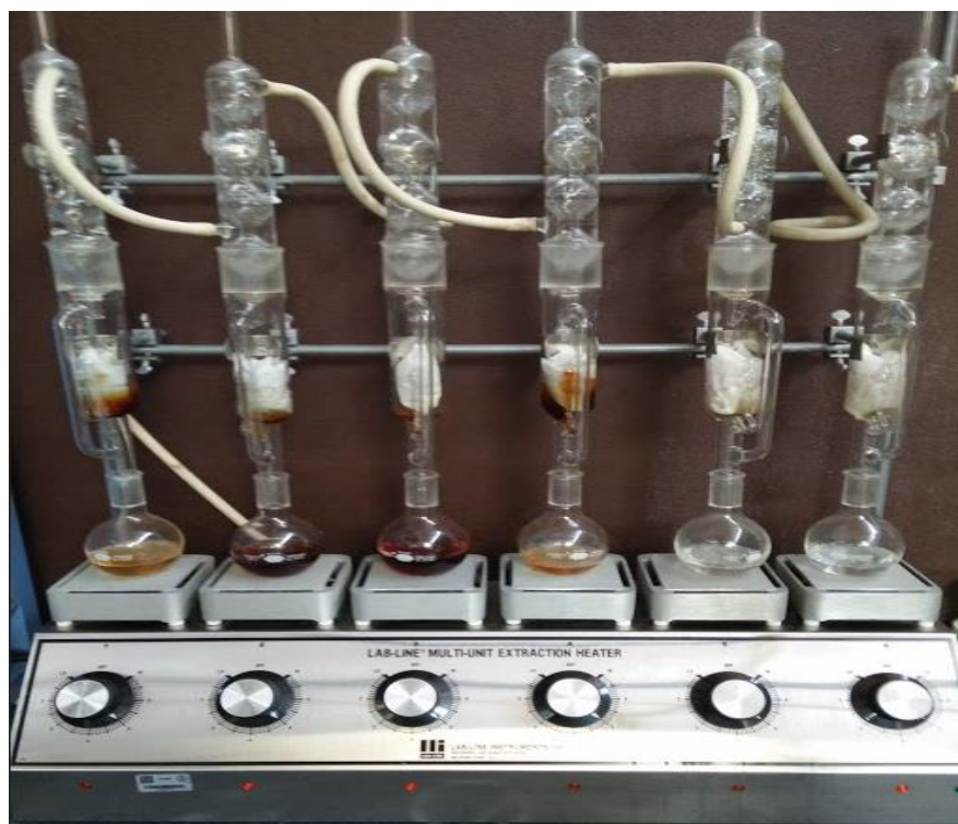
Fig. 6. Unidad de extracción soxhlet.
