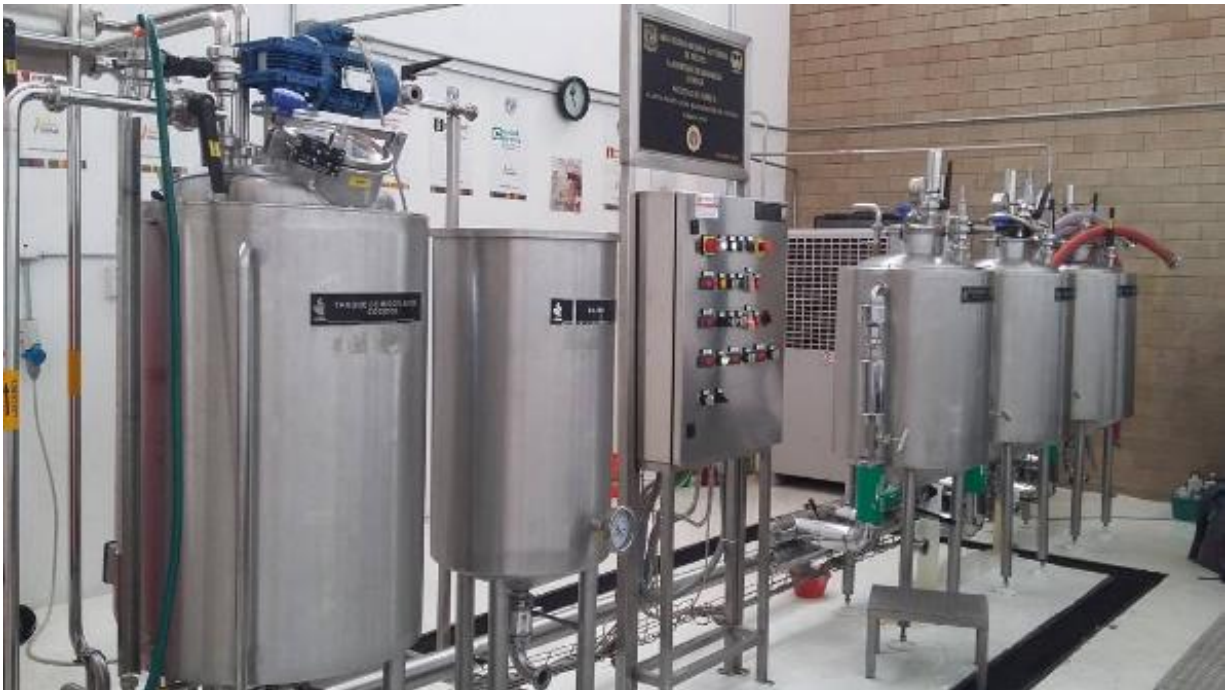
Fig. 48. Planta piloto productora de cerveza.
