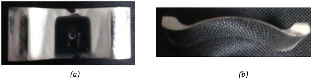
Fig. 3.12. Espejos fabricados en acrílico con depósito de plata, (a) depósito de plata y (b) perfil del espejo.
