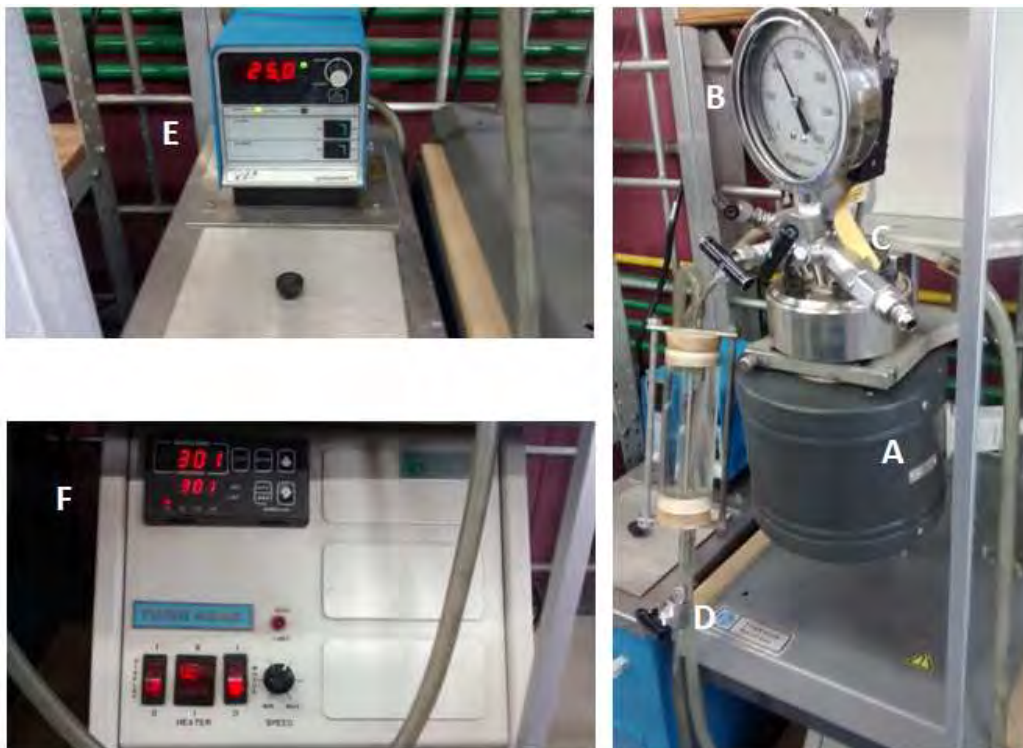
Figura 4.9. Reactor batch e instrumentación. A) Reactor batch y mantilla de calentamiento, B) Manómetro con límite de presión de 3000 psig, C) Termopar estándar tipo J, D) Toma muestras, E) Recirculador de agua, F) Controlador de temperatura.
