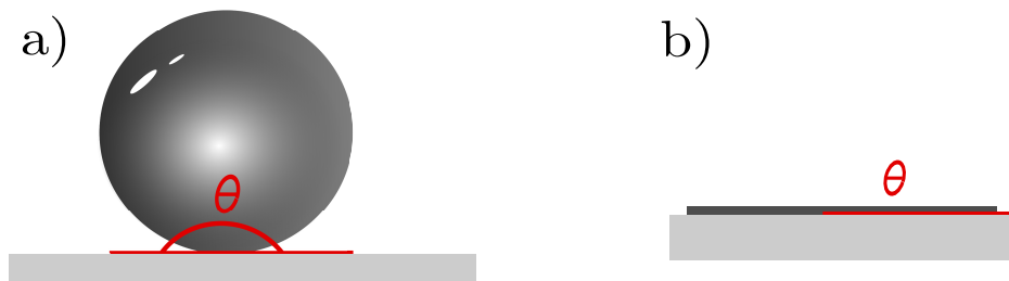
Figura 4.2: Representación de los casos de a) no mojado ( \theta = 180^\circ ) y b) mojado total o completo ( \theta = 0^\circ ).
