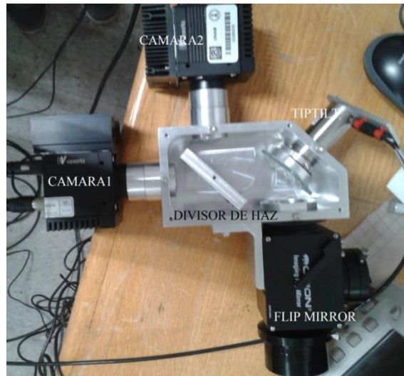
Figura 5.2. Imagen de la estructura diseñada del tip-tilt y sus elementos, para implementación en telescopio.
