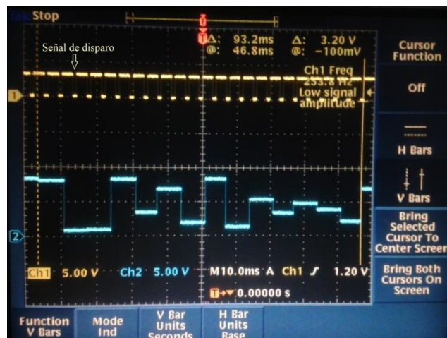
Figura C1. Imagen de comparación en el osciloscopio con disparo en la cámara de 253Hz.
