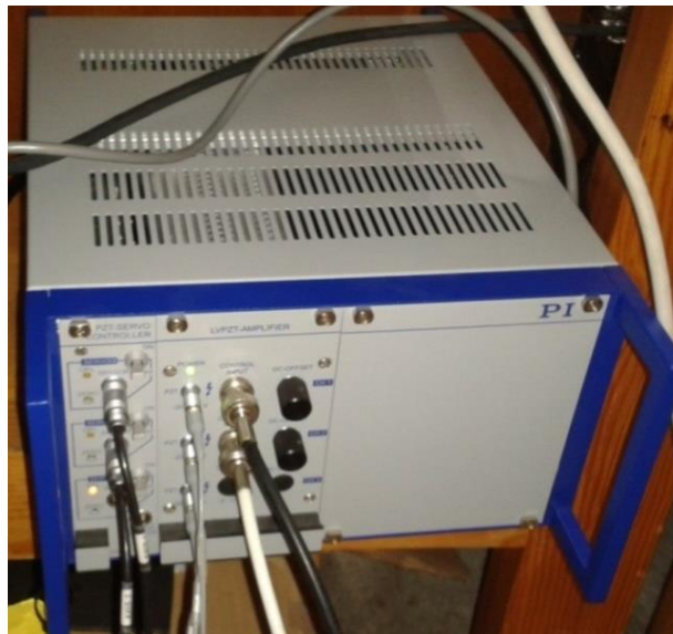
Figura 5.4. Sistema de control para el transductor piezoeléctrico.
