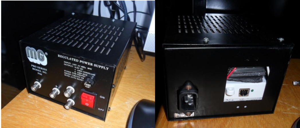
Figura 5.9. Caja con circuito temporizador y convertidor analógico digital para control del espejo tipo “ tip-tilt ”. La fotografía a la izquierda muestra la parte frontal del sistema con dos salidas digitales (conectores BNC en arreglo vertical) y dos salidas analógicas (conectores BNC en arreglo horizontal). En la parte derecha se muestra la parte posterior con el conector USB del convertidor A/D.
