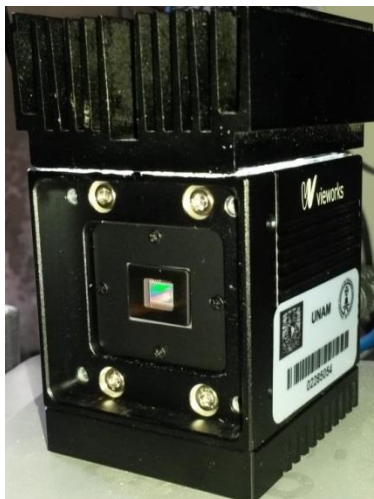
Figura 5.6. Cámara Vieworks utilizada en el sistema como cámara rápida y cámara científica (se utilizan dos cámaras idénticas).
