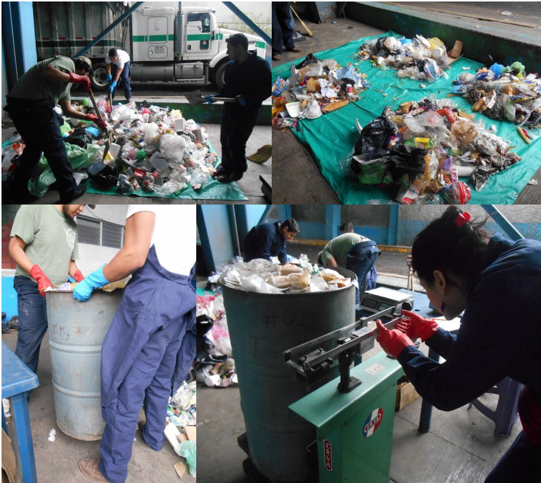
Figura 4.6 Mezcla, cuarteo y peso volumétrico 'in situ'
