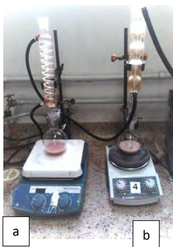
**Figura 27.** Sensibilización de los diferentes sistemas de TiO<sub>2</sub> en polvo. Nanopartículas de TiO<sub>2</sub> sintetizadas en a) medio ácido y b) medio básico por el método sol-gel.
