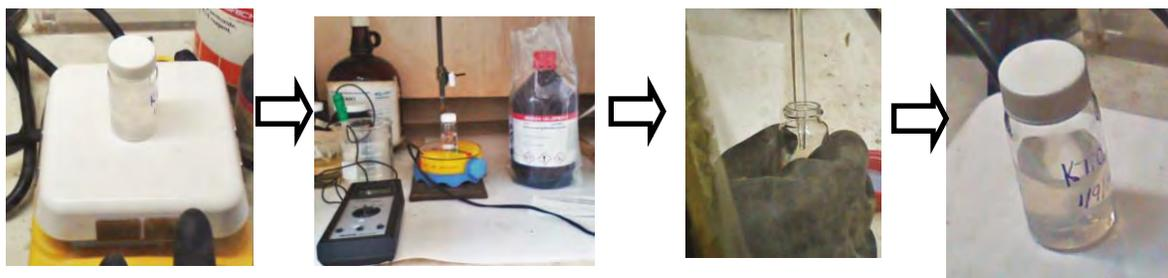
**Figura 23.** Síntesis de nanopartículas de  $\text{TiO}_2$  en medio básico.
