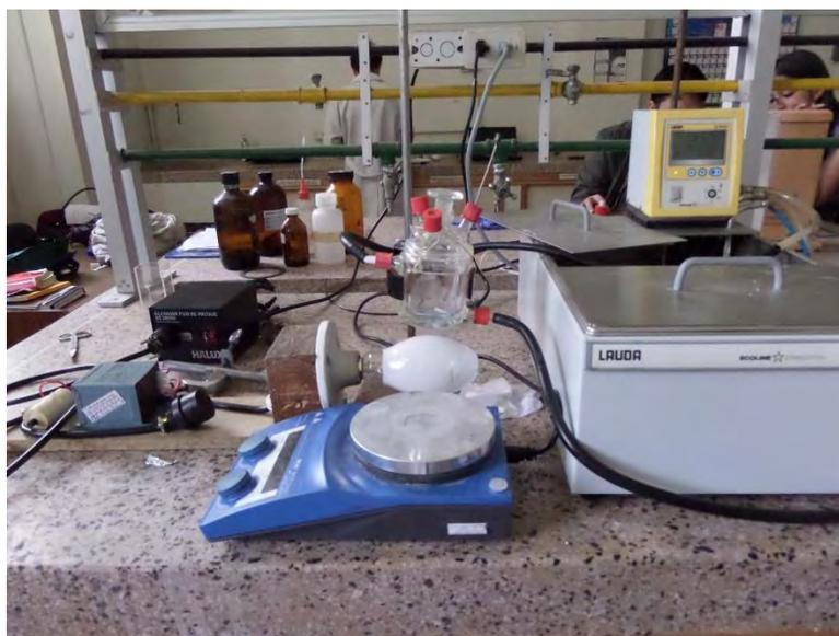
**Figura 28.** Fotoreactor empleado para llevar a cabo la degradación de luminol.
