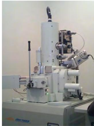
**Figura 17.** Microscopio electrónico de Barrido JEOL 7600F.
