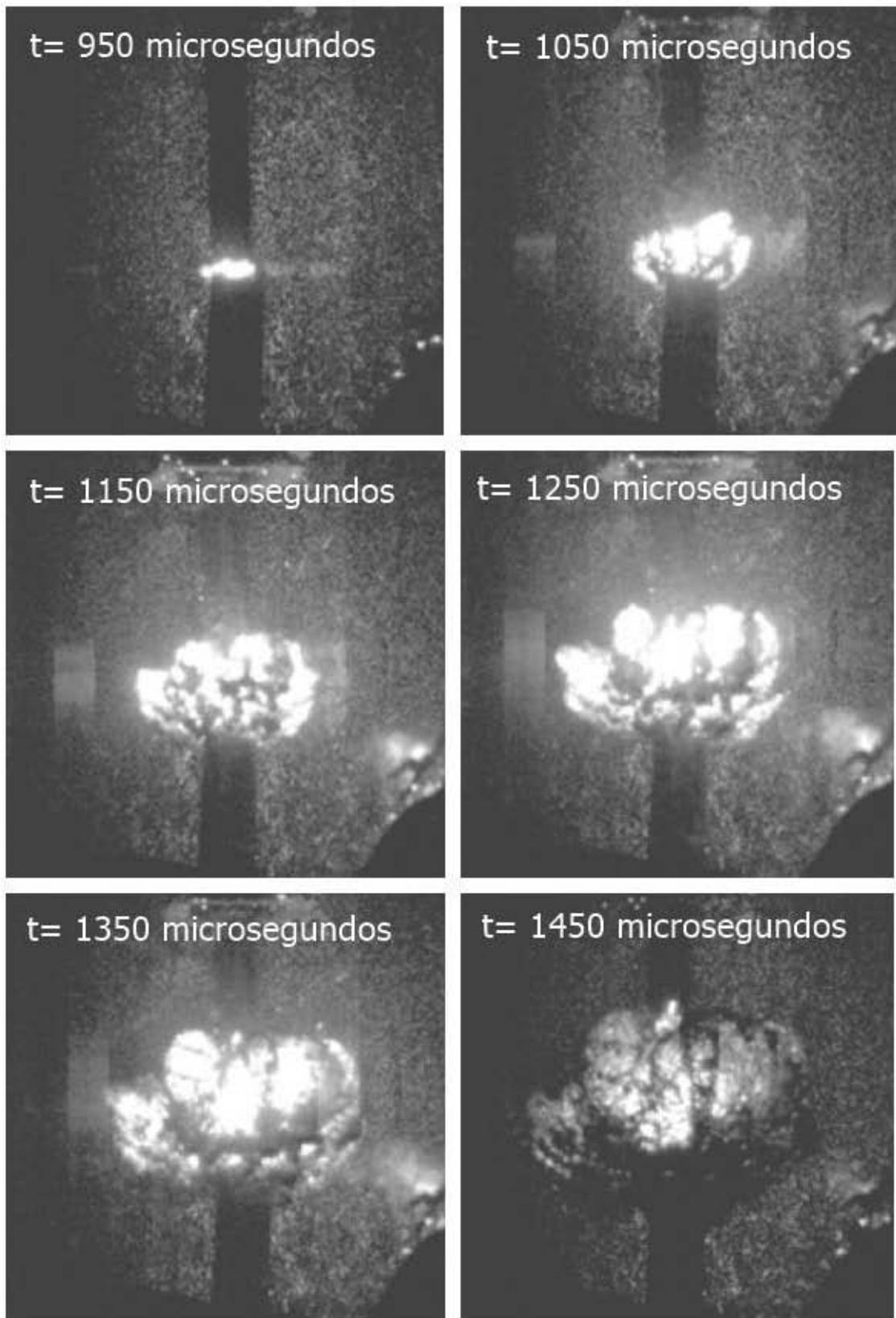
**Figura 6.1:** Expansión a distintos tiempos originada por una chispa a  $900 \mu\text{s}$ -90 V.
