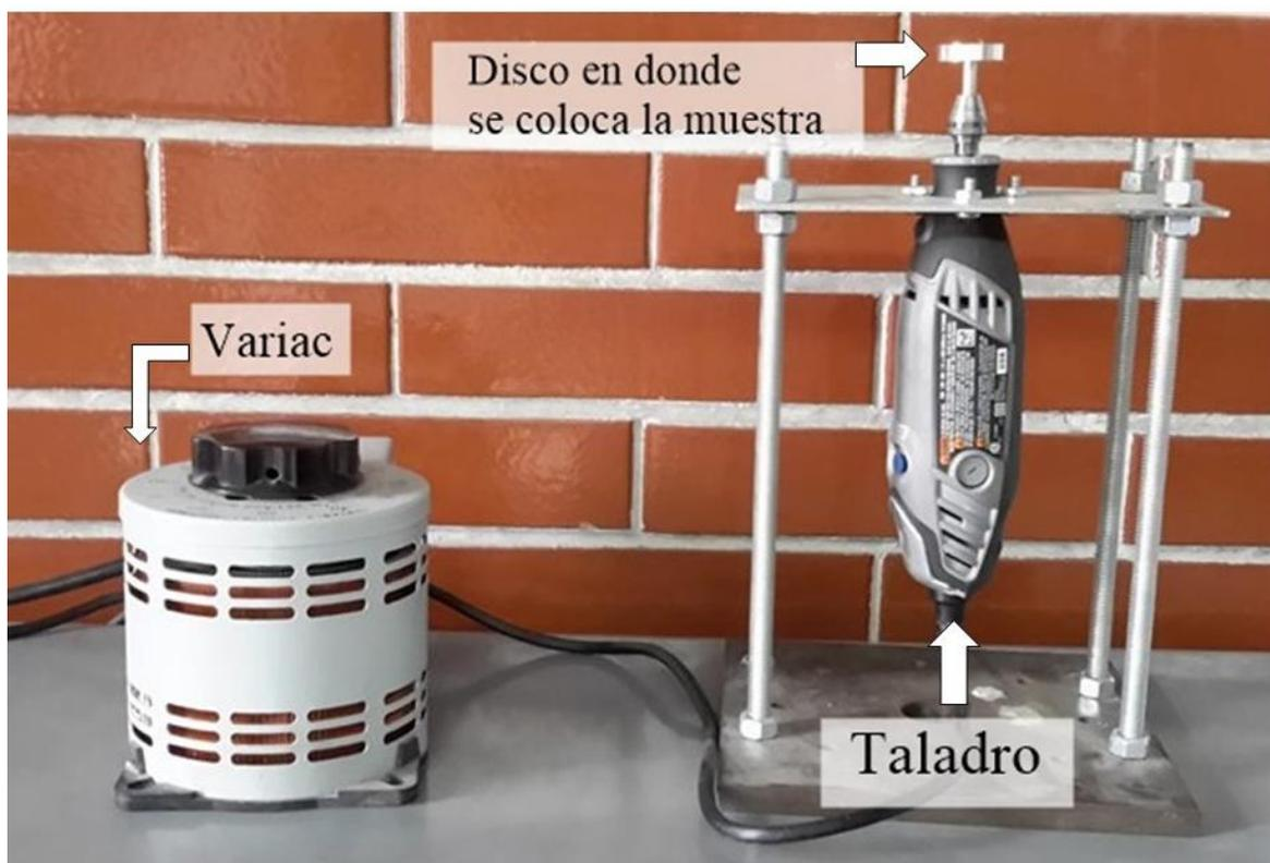
**Figura 4.2:** Spin-coater formado por un variac, un taladro, material encontrado en el laboratorio y un disco para colocar los sustratos de silicio.
