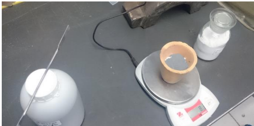
Fig. 3.2. Preparación de la mezcla utilizada para el borurado.
