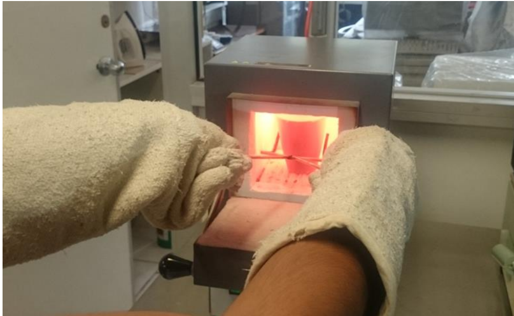
Fig. 3.3. Introducción del crisol con la mezcla borurante.
