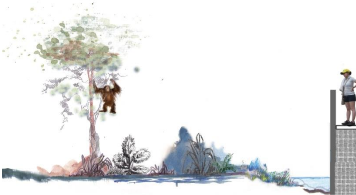
Imagen 153. En lugar de colocar cable electrificado en los árboles, para que las especies no los trepen y salten fuera del exhibidor, colocar los árboles a una distancia adecuada con respecto a los bordes. Dicha distancia se determinará de acuerdo al tamaño de salto de cada animal. [Por Mercedes Mata].
