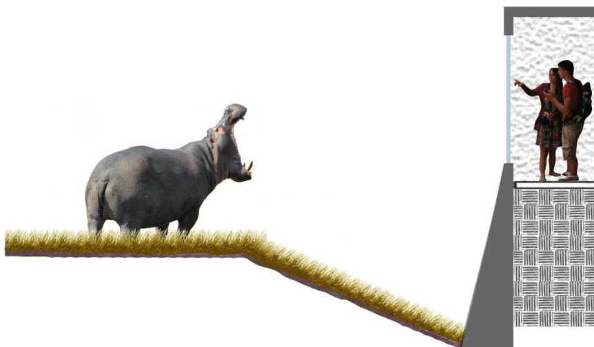
Imagen 151. Las barreras para animales de gran fuerza deberán ser resistentes al empuje de éstos. Así mismo, contemplar siempre pendientes suaves y jamás de 90°, para cualquier especie. [Por Mercedes Mata].
