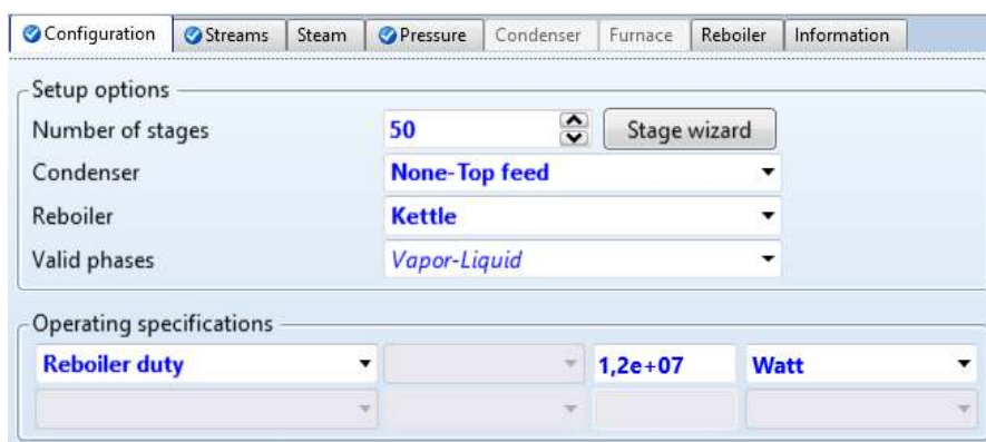
Figura 10: Pantalla de Configuración de Equipo en Aspen V8.8.
